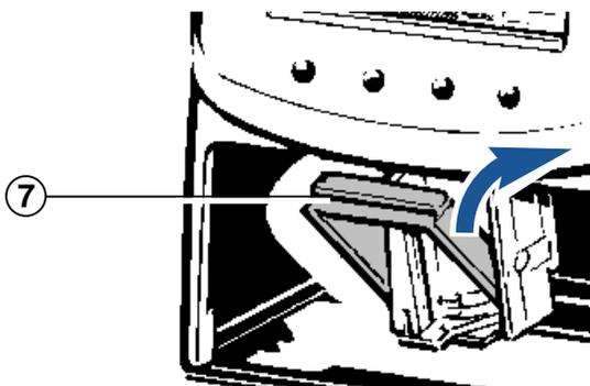
Un chiffon doux (éventuellement imprégné d'alcool) peut également être utilisé pour essuyer l'encre et les éventuelles traces d'encre séchées restant sur le logement de la cartouche d'encre (cf. figure 1)
